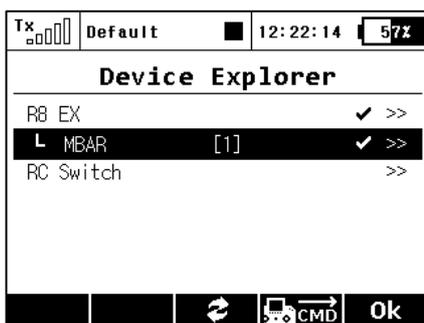
Der MBar EX Sensor kann sehr einfach und übersichtlich über die Geräteübersicht der Duplex DC/DS Sender programmiert werden. **Dazu wird der gebundene Empfänger auf „EX Bus“ umgestellt.** Der Mbar Sensor kommuniziert dann digital und bidirektional mit dem Empfänger. Der Mbar Sensor wird automatisch erkannt und in der Geräteübersicht angezeigt. Sie finden die Geräteübersicht unter: *Menü -> Modellwahl/-modifikation -> Geräteübersicht.*
