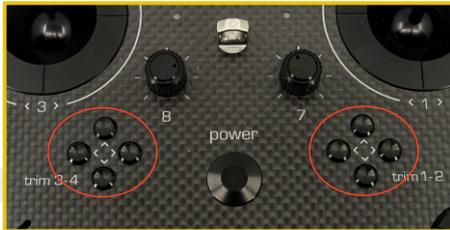
Die Trimmungen werden während des Fluges zur Feineinstellung der Fluglage verwendet. Die Einstellungen der Trimmungen werden automatisch so abgelegt, dass beim Abschalten und Wiedereinschalten des Senders die Trimmwerte beibehalten werden.
