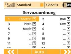
7. Jetzt werden die Servozuordnung bzw Empfängersteckplätze der Funktionen angezeigt. So werden die Drehzahlregler/Servos dann auch mit dem Empfänger verkabelt. Diese Zuordnung kann hier auch getauscht werden, wir empfehlen, die gezeigte Zuordnung einfach zu übernehmen. Das vermeidet Missverständnisse bei den ersten Programmierungen. Dann Bestätigen Sie diese Seite mit der Taste „F5(>>)“.
