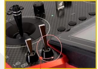
3. Greifen Sie den Schalter an der Platine und ziehen Sie ihn aus seinem Steckplatz.
