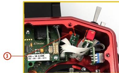
4. Ziehen Sie das Flachbandkabel aus dem Anschluss auf der Hauptplatine.
