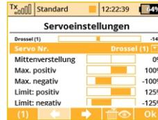
10. Nachjustieren der Servo-Mittelstellungen, Begrenzung des Endausschlags, Umkehr der Drehrichtung, Verzögerung usw. Zu diesem Menü werden wir noch einmal bei der Bindung des Empfängers mit dem Sender zurückkehren. Gehen Sie nach Kapitel **Empfänger->Bindung** vor.
