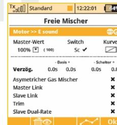
b). Zuordnung des Schalters für die Aktivierung und Deaktivierung des freien Mixers. Mit der Taste „F4(edit)“ wechseln Sie zur erweiterten Konfiguration des freien Mixers und durch Ändern des Parameters „Switch“ ordnen Sie den Geber für die Aktivierung/Deaktivierung des Mixers zu.
