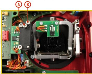
Wollen Sie eine **Rastwirkung**, ziehen Sie schrittweise die mit „**A** bezeichnete Einstellschraube der Rast-Bremse“ (im Uhrzeigersinn) bis zu dem Punkt an, bis bei Knüppelbewegung die Einzelschritte des Knüppels in gewünschter Stärke „**spürbar**“ werden. Lösen Sie die mit „**B** bezeichnete Einstellschraube der weichen Bremse“ (gegen den Uhrzeigersinn).
