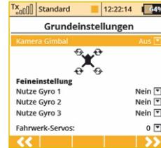
5. In den Grundeinstellungen werden die entsprechenden Steueroptionen eines Multicopters angezeigt und ausgewählt. Diese sind Kameragimbal "nein/2 Achsen/3 Achsen", die gewünschten Gyrostabilisierungsfunktionen und die Anzahl der Landegestellservos/-funktionen. Dann wieder die Taste „F5(>>)“.
