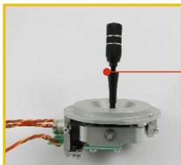
8. Lösen Sie das (geriffelte) Knüppeloberteil (durch Drehen entgegen dem Uhrzeigersinn)
