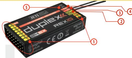
1. Die Servoanschlüsse passen universell für die meisten Servos mit UNI Stecker – bei Futaba-kompatiblen Servosteckern muss die „Nase“ am Stecker entfernt werden.
