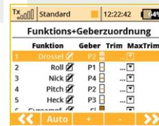
6. Im Menü „**Funktions + Geberzuordnung**“ wird das Verzeichnis der Steuerfunktionen mit deren Geberzuordnung abgebildet. Falls Sie diese Zuordnung ändern wollen editieren Sie den Parameter „**Geber**“ und ordnen den gewünschten Geber der markierten Steuerfunktion zu. Bestätigen Sie mit der Taste „**F5(>>)**“.
