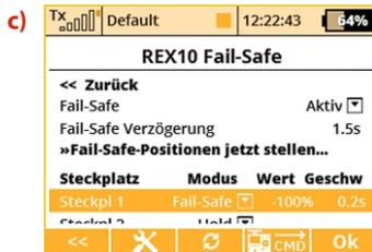
Position halten und diese dann gesammelt zum Empfänger übertragen. Unter dem nächsten Punkt "Steckplatz - Modus" können Sie diese Fail-Safe-Position nun für jeden gewünschten Steckplatz am Empfänger aktivieren.
