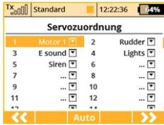
7. Zuordnung der Sender-Ausgangsfunktionen zu den Empfängerkanälen (Ausgängen). Haben wir im vorhergehenden Menü die Funktionen in der Reihenfolge erstellt, in der sie an den Empfängeranschlüssen erscheinen sollen, müssen wir diese Konfiguration nicht weiter umstellen. Bestätigen Sie mit der Taste „F5(>>)“.
