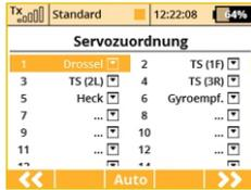
7. Das Menü „**Servoanordnung**“ beinhaltet die Zuordnung von Ausgangsfunktionen des Senders zu den einzelnen Kanälen (Ausgängen) des Empfängers. Wollen Sie die Zuordnung ändern, ändern Sie die einzelnen Positionen des Verzeichnisses, zum Fortsetzen betätigen Sie die Taste „**F5(>>)**“.
