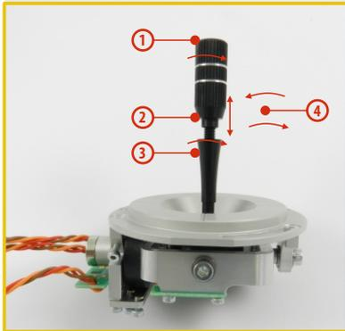
1. Ergreifen Sie den geriffelten Oberteil des Knüppels und lösen ihn durch Drehung entgegen dem Uhrzeigersinn.
