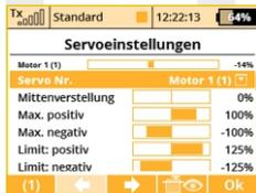
9. Nachjustieren der Servo-Mittelstellungen, Begrenzung des Endausschlags, Umkehr der Drehrichtung, Verzögerung usw. Zu diesem Menü werden wir noch einmal bei der Bindung des Empfängers mit dem Sender zurückkehren. Gehen Sie nach Kapitel Empfänger->Bindung vor. Bestätigen Sie mit Taste „F5(Ok)“.
