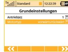
5. Der erste Parameter im Menü „**Grundeinstellung**“ ist die Anzahl der gesteuerten Motoren im Modell. Diesen Parameter werden wir nicht ändern und wechseln zum nächsten der die Art der Motorsteuerung definiert. Dreht der Motor nur in eine Richtung (nur vorwärts) oder in beiden Richtungen (vorwärts/rückwärts)? Wir ändern die Einstellung „**Motortyp**“ auf „**vorwärts/rückwärts**“ und bestätigen mit der Taste „F5(>>)“.
