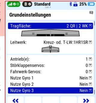
**Leitwerk:** Kreuz- oder T-LW: 1HR/1SR (1x Seitenruderservo + 1 Höhenruderservo).
