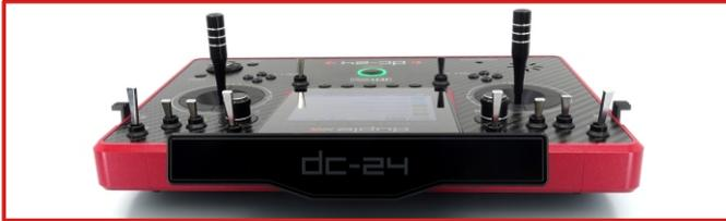
**Warnung:** Die Antennen in diesem Antennenvorbau im Betrieb nicht anfassen oder sonst wie abschirmen. Das könnte zu einem deutlichen Verlust der Reichweite führen.
