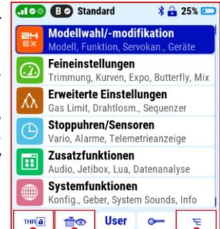
2. Das Symbol mit einem Servo und einem Auge („**F2**“-Taste) öffnet direkt den Servo-Monitor (Servoweganzeige).
