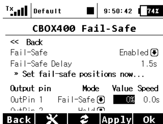
Obr. 25: Připojená zařízení - Fail Safe
